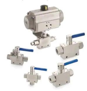
Шаровые краны цапфового типа серии СТВ обеспечивают срабатывание при повороте на четверть оборота с малым крутящим моментом и имеют компактную конструкцию, обеспечивающую надежное отсечение под давлением до 20 000 фунтов на кв. дюйм, ман. (1378 бар). Эти краны предлагаются для эксплуатации в высокосернистой газовой среде с материалами, подобранными в соответствии с требованиями стандарта NACE MR0175/ISO 15156.
