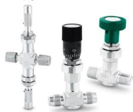
Компания предлагает несколько типов дозирующих клапанов для использования в системах с низким и высоким давлением. Данные клапаны изготавливаются из нержавеющей стали марки 316 и латуни, имеют коэффициенты расхода от 0,004 до 0,16 и предназначены для слабого, среднего и интенсивного потока.
